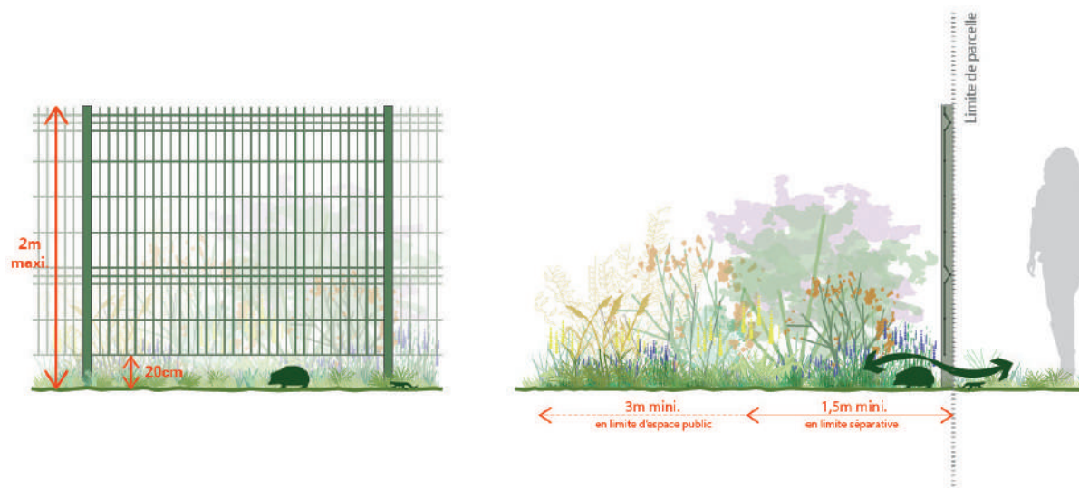
Schéma d'installation de clôture
