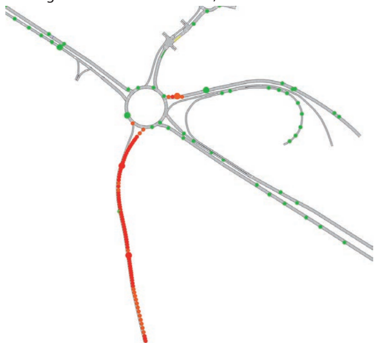
Remontée de file sur la branche Sud de l'échangeur Sud en HPM
